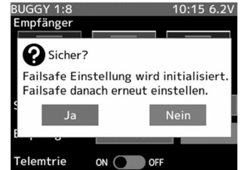
Die Anzeige macht darauf aufmerksam dass die Failsafe Einstellungen initialisiert wird und dass die Failsafe Einstellung erneut eingestellt werden muss.
