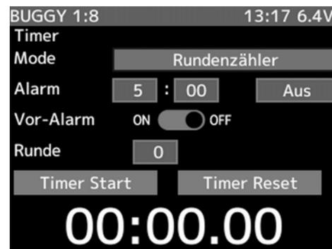
Für die Betätigung des Rundenzeiten Zählers müssen Schalter/ Taster für Start und Stopp-Reset zugeordnet werden. Die Zuordnung der Schalter/Taster ist im Kap. 49 beschrieben.
