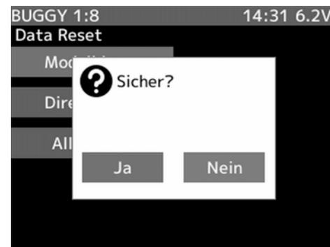
2. Drücken Sie die „JOG“-Taste. Eine Sicherheitsabfrage erscheint, „SICHER?“. Beantworten Sie die Frage mit „JA“ um die Daten zu löschen.
