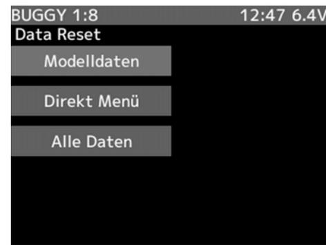
1. Die Auswahl der 3 unterschiedlichen Löscharten erfolgt mit der „JOG“-Taste. Es wird immer nur das aktuell ausgewählte Modell gelöscht, eine Modellspeicher-Auswahl ist nicht möglich.
