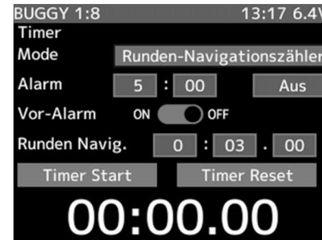
Für die Betätigung der Uhrenfunktionen muss ein Schalter ausgewählt werden. Die Zuordnung der Schalter ist im Kap. 49 beschrieben.
