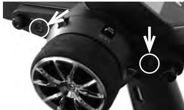
Setzen Sie das Lenkrad wieder ein und schrauben sie dieses wieder fest.
