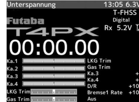
Sobald die Akkuspannung auf die entsprechend unter „BATTERIE“ eingestellte Spannung sinkt, zeigt das Display 'Unterspannung' an und ein Warnsignal ertönt. In diesem Fall muss der Betrieb des Senders umgehend eingestellt werden. Wenn die Akkuspannung noch weiter zurück geht, können Sie die Kontrolle über das Fahrzeug verlieren.
