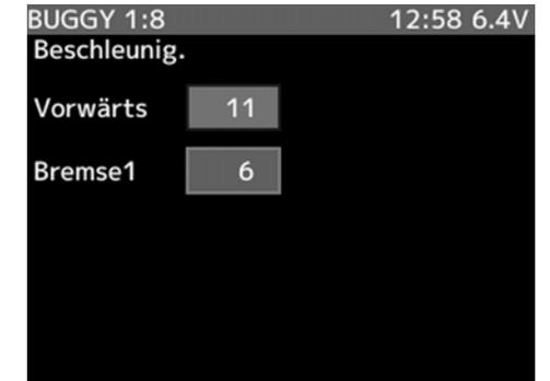
Die Einstellung der Werte erfolgt mit der (+)- oder der (-)-Taste. Um zur Grundeinstellung (0%) zurück zu kommen, muss die (+)- und die (-)-Taste gleichzeitig für min. 1 Sekunde betätigt werden.
