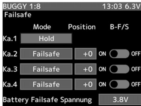
Die Abbildung zeigt das Display in der Einstellmenü-Ebene. Angezeigt wird die jeweilige Fail-Safe Einstellung der vier Kanäle und die aktuelle Vorgabe der Unterspannungserkennung.
