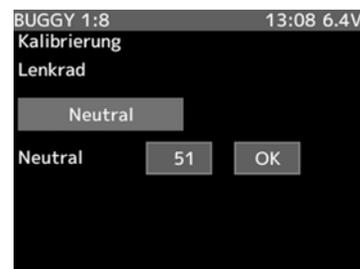
2. Danach gleichen Sie die Endausschläge der Lenkung sowohl für die rechte als auch für die linke Seite ab. Dazu drehen Sie das Lenkrad voll nach links und nach rechts und betätigen danach die 'JOG'-Taste. Damit erfolgt der Abgleich des Gebers für die Endausschläge.
