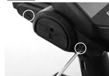
Lösen Sie die zwei Inbus Schrauben auf der linken Seite mit einem 2,5mm Inbus Schraubendreher und nehmen Sie die Abdeckung ab.
