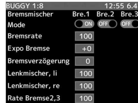
Die Abbildung zeigt das Einstell-Menü der BREMSMISCHER Funktion. Die Einstellung der Werte erfolgt mit der (+)- oder der (-)-Taste.
