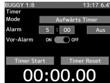
**Für die Betätigung der Uhrenfunktionen müssen Schalter/ Taster für Start und Stopp/Reset aktiviert werden. Die Zuordnung der Schalter/ Taster ist im Kap. 49 (Schalter Auswahl) beschrieben.**
