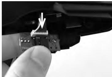
Schließen Sie den Stecker der Ladeplatine wieder an. Danach die Ladeplatine wieder in die vorgesehene Halterung einsetzen.
