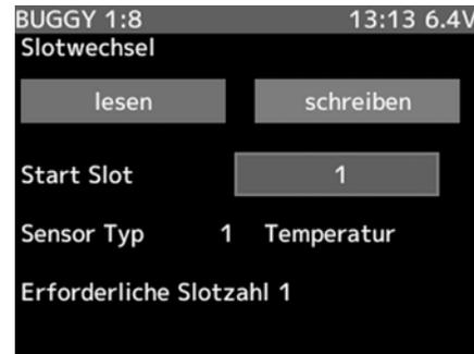
Wählen Sie nun die Zahlen-Taste in der Zeile „**Start Slot**“ aus. Die Nummer kann wie gewohnt verändert werden. Allerdings werden nur die freien Slots angezeigt auf den der Sensor eingestellt werden kann.
