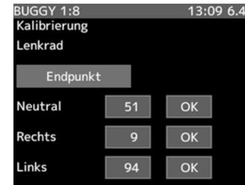
3. Zum endgültigen Abschluss des Vorganges betätigen Sie die (END)-Taste.
