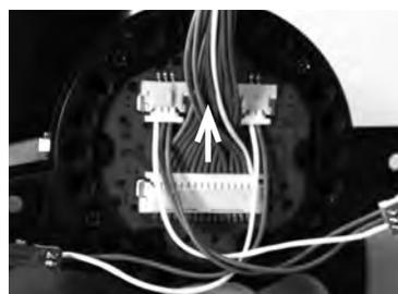
Danach Lenkrad nach vorne abnehmen. Ziehen Sie das Hauptkabel vom Stecker am Lenkrad ab.
