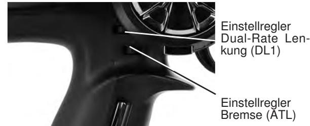
Über die Taster DT5 und DT6 werden die Funktionen Dual Rate und ATL eingestellt. Die Geber für die Funktionen können im Menü „Geber Auswahl“ Kap. 48 geändert werden.
