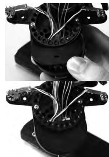
Anschließend die Plastikabdeckung in das Unterteil des Adapters einklicken.
