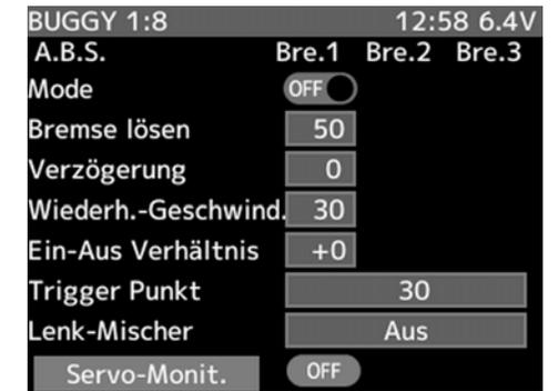
Im unteren Teil des Displays wird über den Servo Monitor die Position des Gebers für die Gasfunktion angezeigt. Über diese Anzeige wird die ABS-Funktion überprüft.
