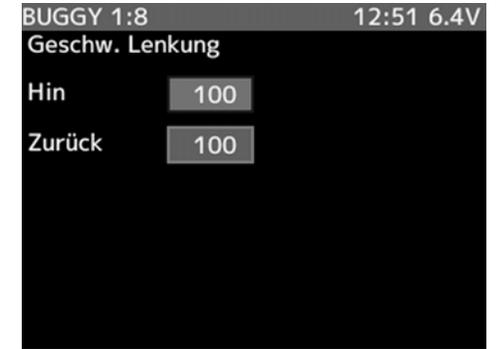
Die Einstellung der Geschwindigkeit des Lenkservos erfolgt mit der (+)- oder der (-)-Taste. Dabei kann der Bereich zwischen 1 und 100% programmiert werden. Um zur Grundeinstellung (100%) zurück zu kommen, muss die (+)- und die (-)-Taste gleichzeitig für min. 1 Sekunde betätigt werden.
