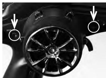
Lösen Sie die zwei Inbus Schrauben mit einem 2,5 mm Inbus Schraubendreher.
