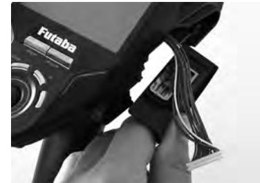
Ziehen Sie vorsichtig den Stecker des Lenkradkabels ab und entnehmen Sie die Lenkrad Einschubabdeckung. Diese muss auf der linken Seite wieder eingesetzt werden. Führen Sie das
